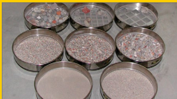
toetsing granulaat aan de BRL 2506-norm
