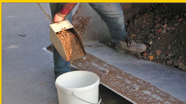
monsterafname van het granulaat
