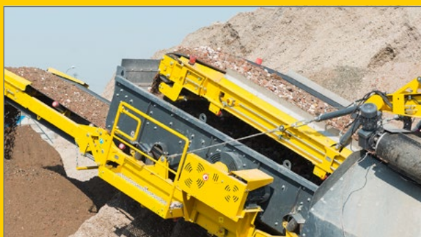
aanvoer gebroken materiaal naar zeef
