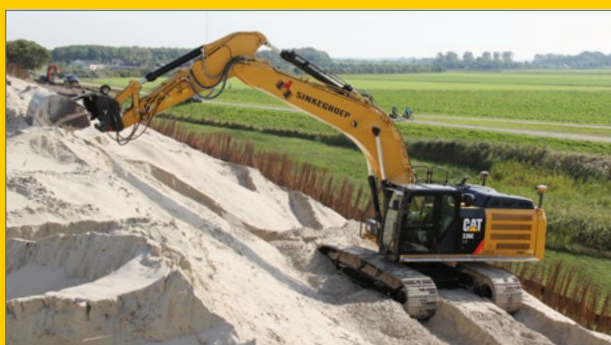
36-tons rupskraan met kantelstuk en GPS-besturing
